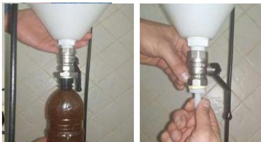
7. Установите , используя уплотнитель ( в комплекте),гидрозатвор и наклейте жк термометр на корпус ферментера.
