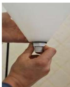
4. Установите пластиковый переходник в кран Для исключения протеканий, установите между переходником и краном уплотнитель ( в комплекте) Плотно затяните переходник зажимной гайкой.
