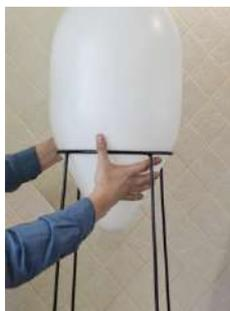
3. Установите пластиковый отвод с уплотнителем в нижнее отверстие бака, **рекомендуется установка силиконовой прокладки только внутри бака**, с усилием закрутить гайку.
