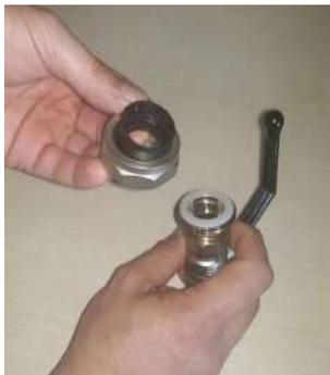
5. Подсоедините кран к отводу. Для исключения протеканий рекомендуется уплотнять резьбовые соединения сантехнической ФУМ-лентой.
